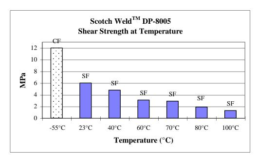
SF : Substrate Failure, CF : Cohesive failure
