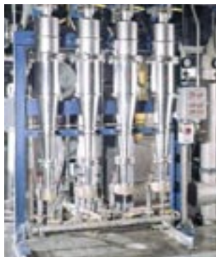
Odstředivé čističe na čtyřválcovém papírenském stroji
